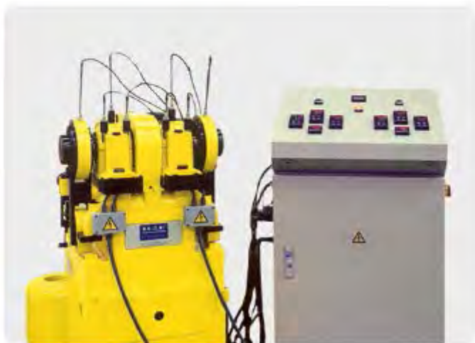
Машина R2F для испытания пластичной смазки
