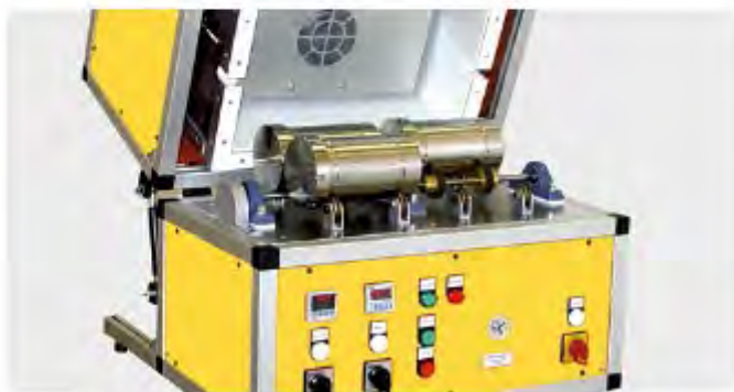
Машина для испытания стабильности при перекачивании
