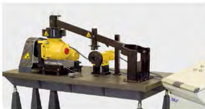
Машина V2F для испытания пластичной смазки
