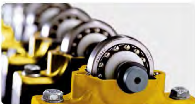
Машина Етсог для испытания пластичной смазки
