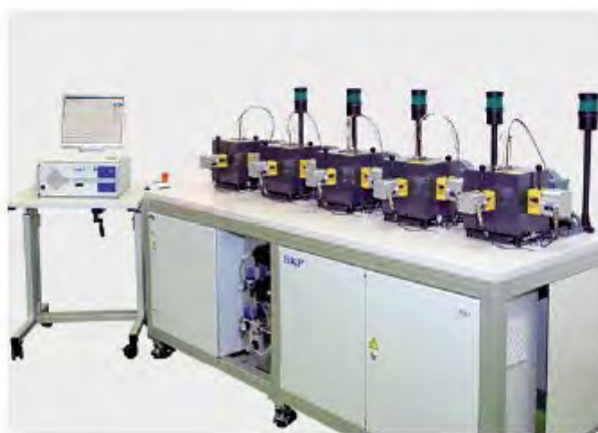
Машина ROF+ для испытания пластичной смазки
